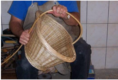
Figure 130 - Pose de la sous-anse
