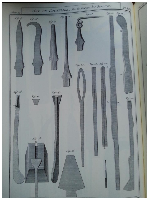
Descriptif de la forge des ressorts : Planche XXX extraite de "L'Art du coutelier" par M. Jean-Jacques PERRET, Maître Coutelier, 1771.
