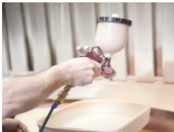
Engobage par projection d'une pièce crue
