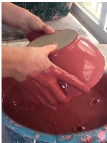
Engobage par trempage
