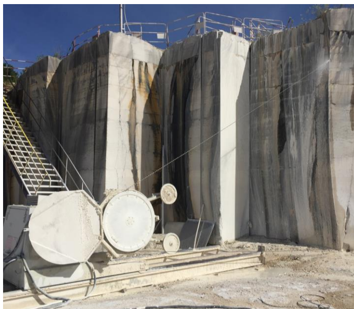
Fig. 22 : Machine de sciage au câble diamanté à front de taille en découpe verticale
