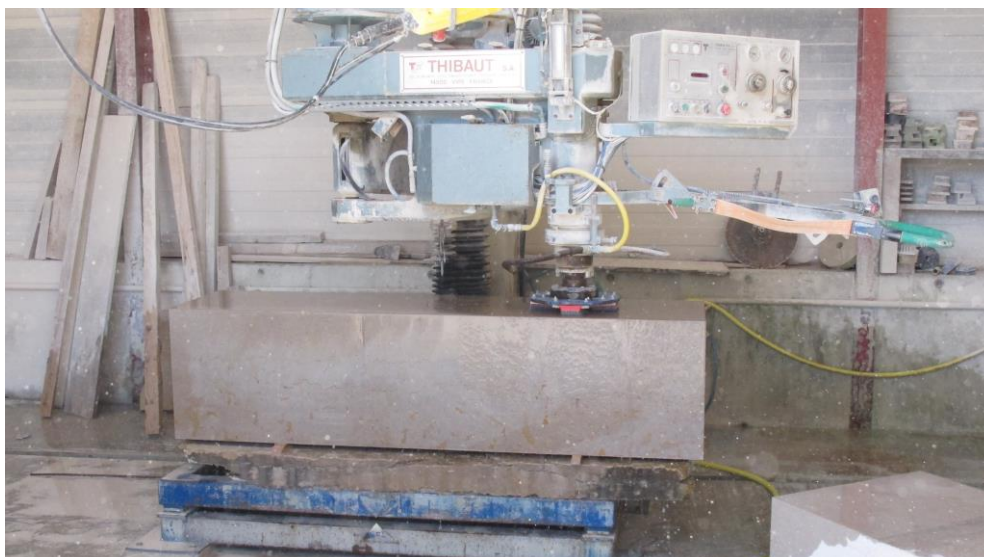
Fig. 45 : Machine de type « genouillère » utilisée pour les traitements de surface de façon manuelle (polissage, adoucissage ou brossage).
