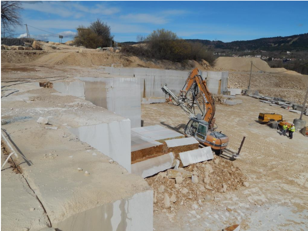
Fig.29 : Machine de perforation pneumatique embarquée sur chenille
