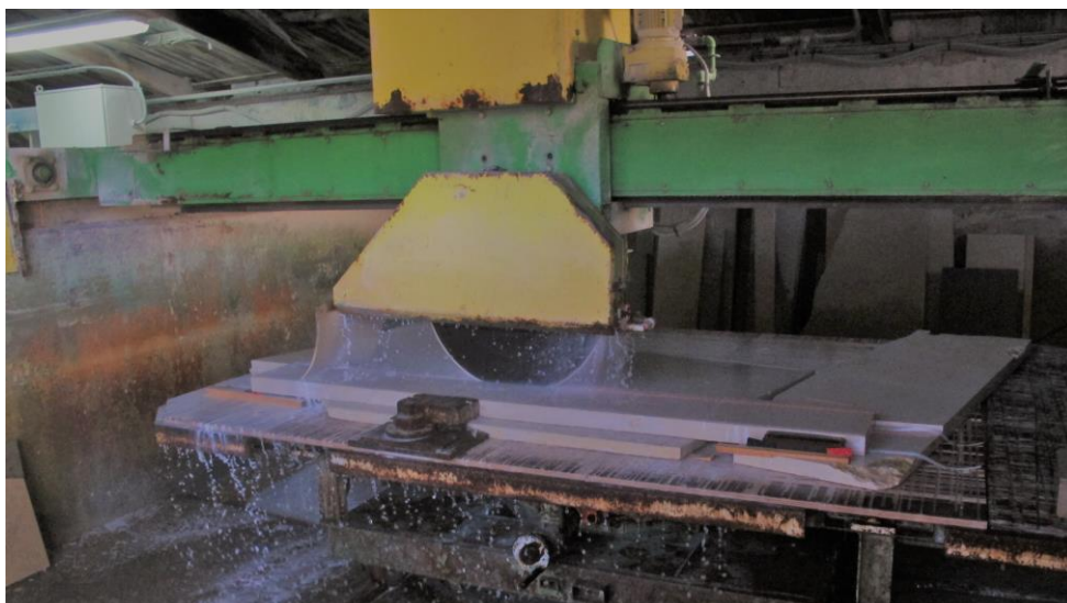
Fig.36 : Débriteuses équipées de disque diamanté pour la recoupe de tranches venant du sciage primaire.
