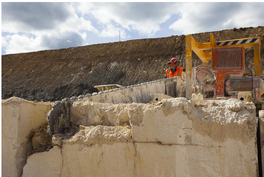
Fig. 28 : Détail du bras de la haveuse engagé dans la coupe
