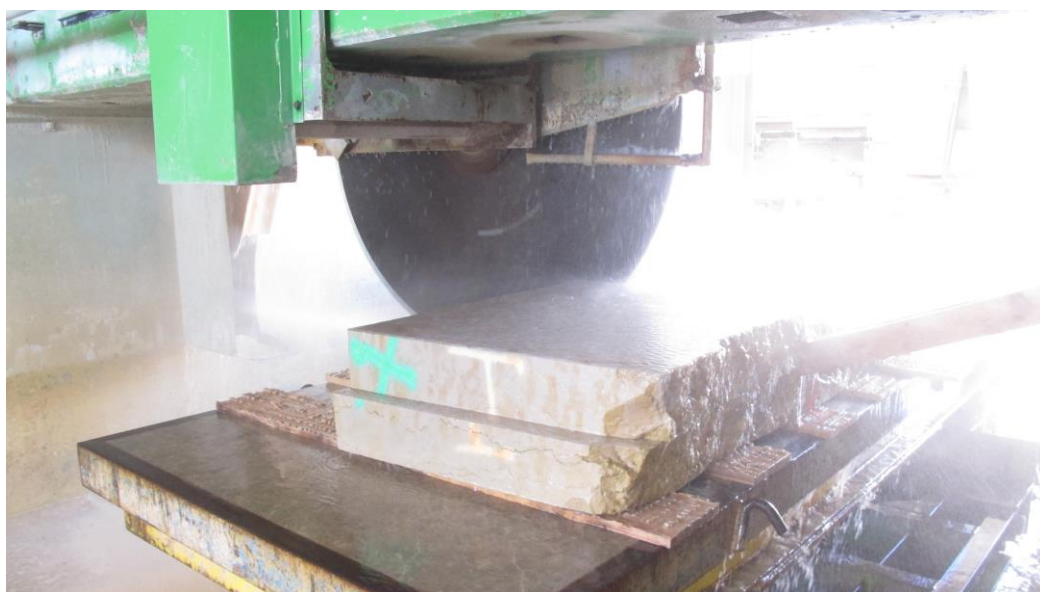
Fig.37 : Débriteuses équipées de disque diamanté pour la recoupe de tranches venant du sciage primaire.
