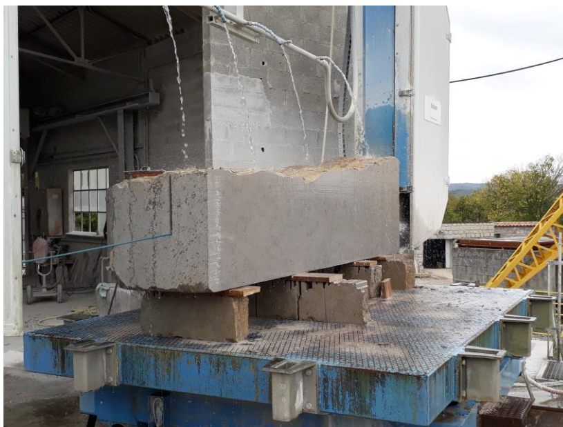
Fig.33 : Machine ancienne au fil carbo modifiée pour scier au câble diamanté
