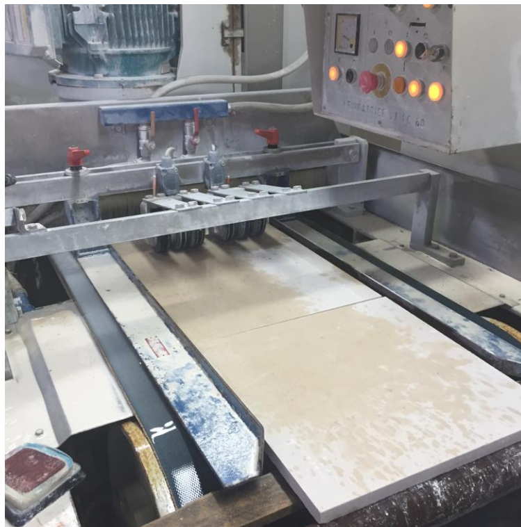
Fig. 48 : Machine de polissage en ligne avec plusieurs têtes embarquées pour obtenir le polissage de carreaux ou de dalles.
