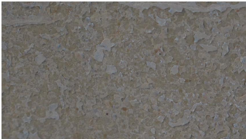
Fig. 43 : Etat de surface dit « flammé » obtenu par l'action de flammage au chalumeau.
