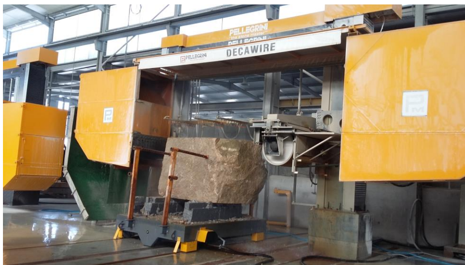
Fig.35 : Machine de sciage type multi-fil (ici 10 fils) pouvant couper plusieurs tranches à chaque descente.
