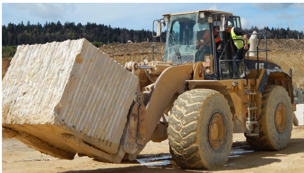
Fig.30 : Manutention des blocs de pierres se fait généralement par chariots élévateurs
