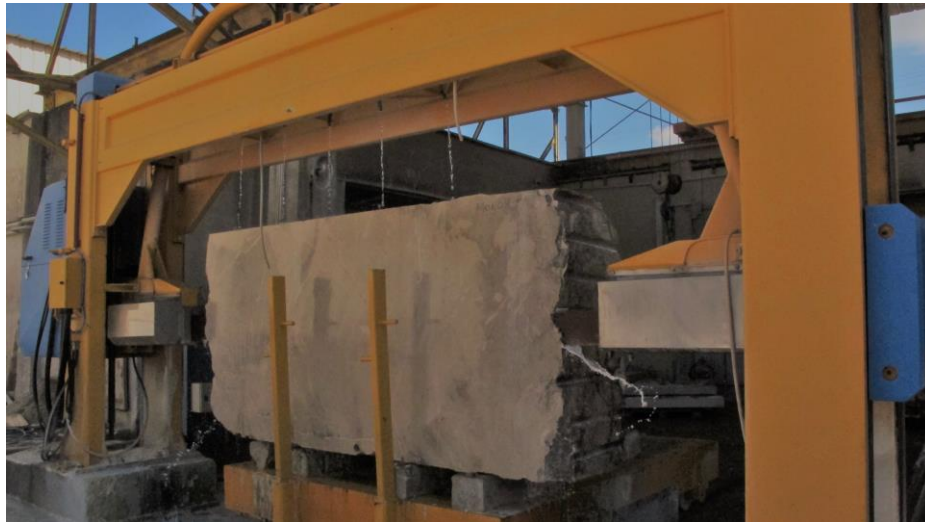
Fig.32 : Châssis dit monolame ne pouvant réaliser qu'une coupe à chaque descente
