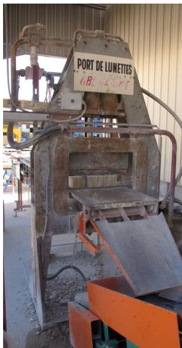
Fig. 47 : Machine de clivage ou éclateuse permettant la réalisation de pavés éclatés ou de dalles à poser.
