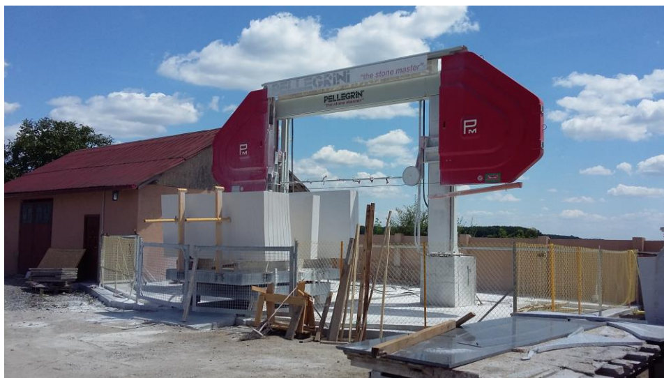
Fig.34 : Machine moderne de marque Pellegrini pour le sciage au fil diamanté.
