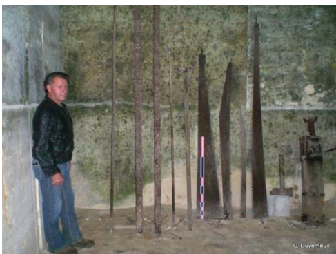
Outils des carriers au XIX e – début XX e siècle en Périgord, présentés par Jean-Noël Boucau. On reconnaît de gauche à droite : une aiguille, deux pincés à talon, une aiguille, une piche, quatre scies crocodile, un marteau taillant et un cric..... (Source : G Duverneuill)
