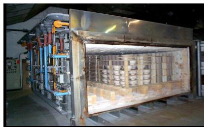
Enfournement des charges dans le four de dégourdi
