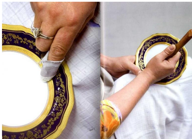
Technique d'incrustation : polissage à l'agate
