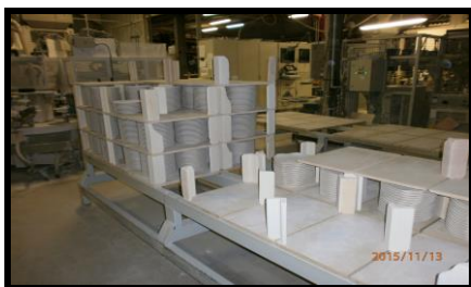
Montage manuel de la charge
