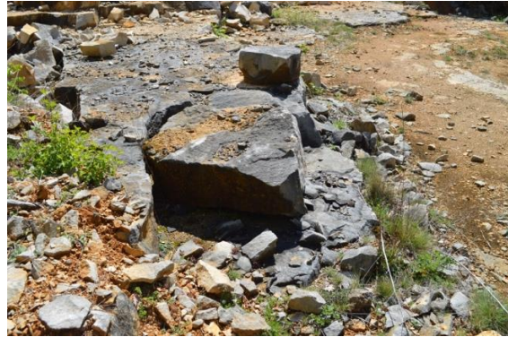
(B) bloc non enlevé, dégagé suivant les lignes de fractures naturelles – carrières de Beauzens
