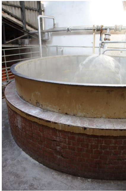
Lavage au cours de la cuisson du Savon de Marseille
