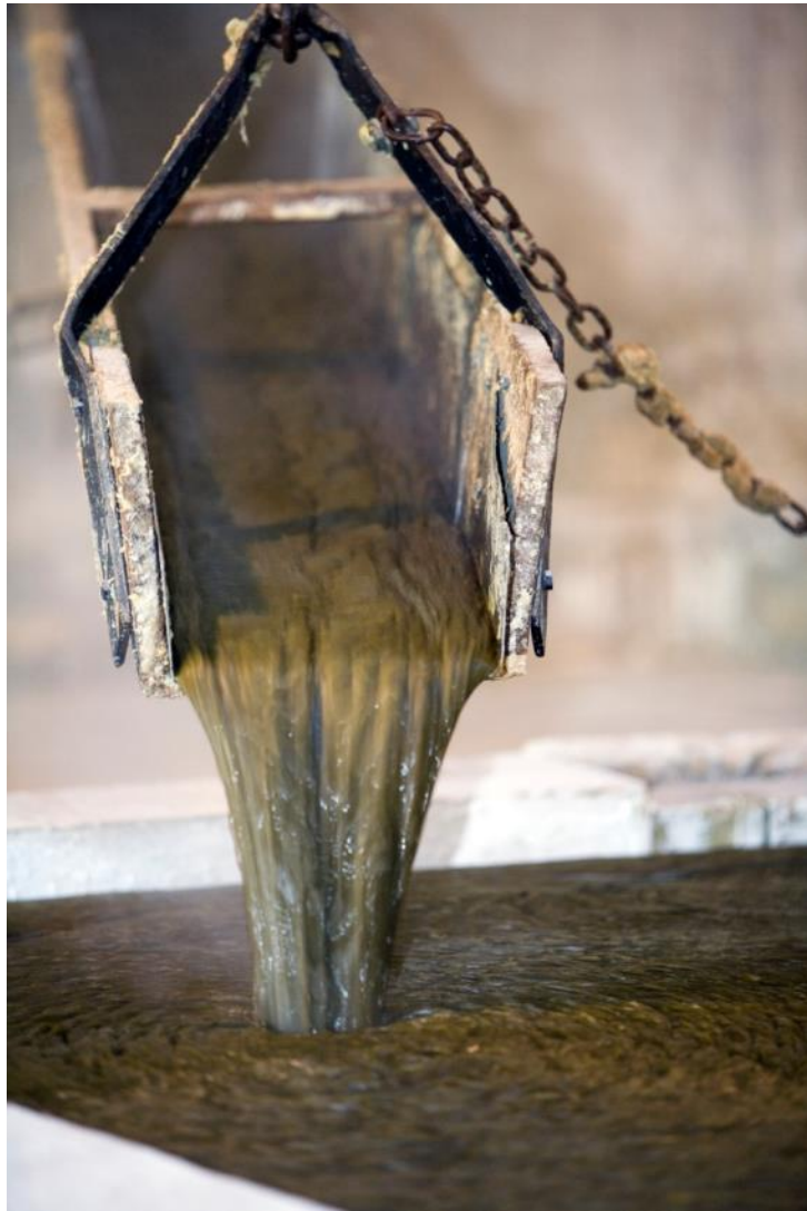
Coulée du Savon de Marseille dans les « mises »
