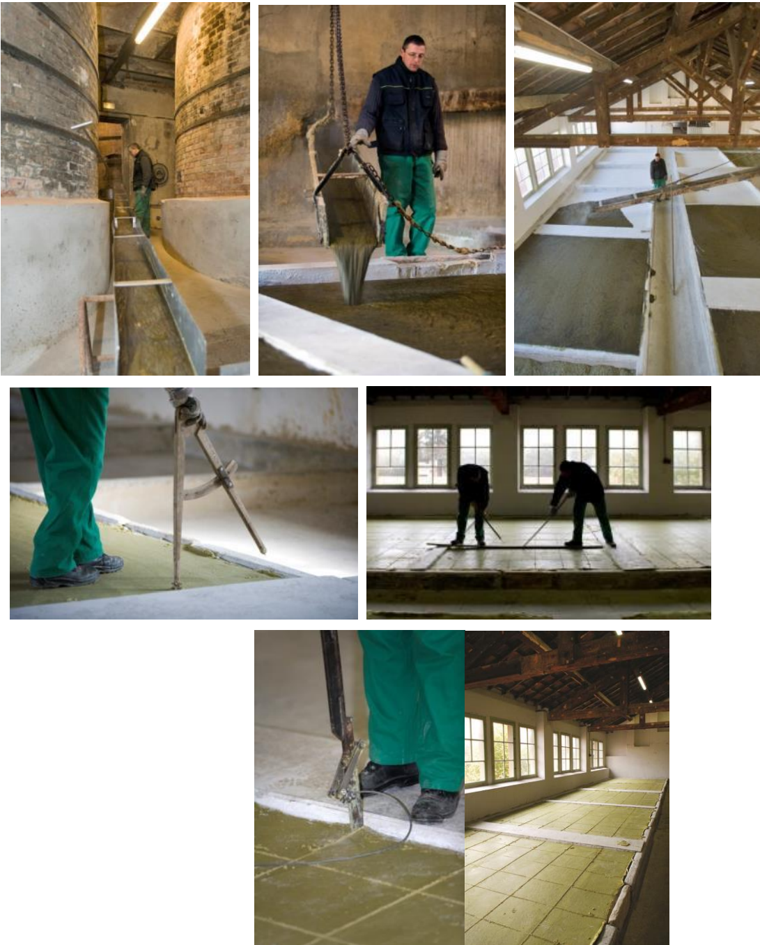
Coulée et séchage du Savon de Marseille dans la salle des « mises » Source : Savonnerie Marius Fabre
