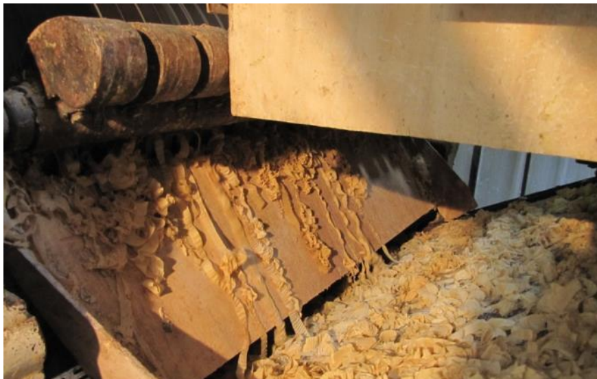
Séchage par déshydratation, sur cylindre refroidisseur (copeaux de savon)
