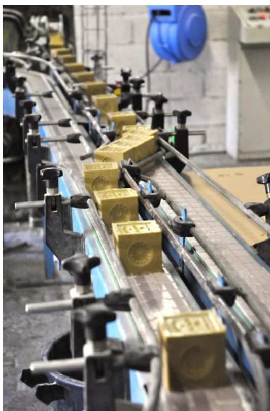
Le moulage du cube de Savon de Marseille
