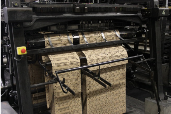
Jacquard sur le métier (à gauche), commande numérique du métier (à droite) - Source : FFDB
