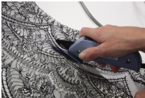
Ecaillage de la dentelle - Source : FFDB
