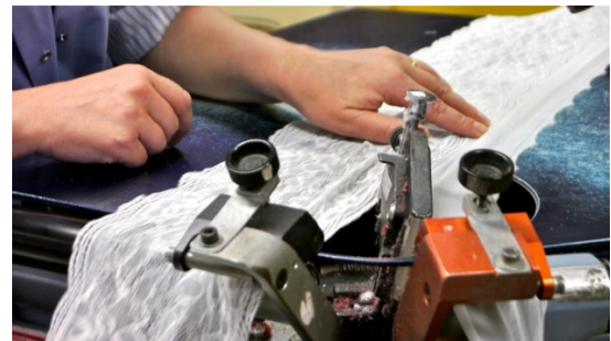
Ecaillage de la dentelle - Source : FFDB
