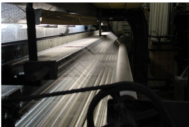
Rouleaux positionnés à l'arrière du métier Leavers (à gauche) et passage des fils à travers le métier (à droite) – Source FFDB
