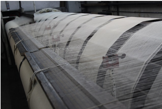
Remplissage des gros rouleaux de chaîne ou ensouples (à gauche) et remplissage des petits rouleaux (à droite) –
