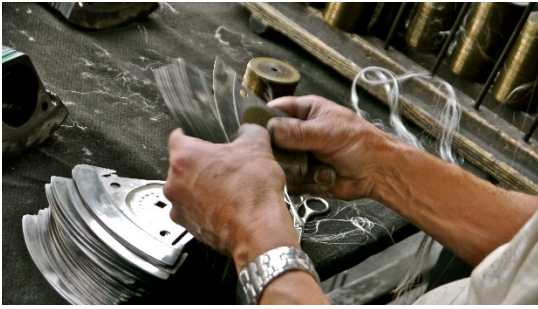
Remontage des bobines dans leur chariot (à gauche) et chariot bobine (à droite) /Source :FFDB
