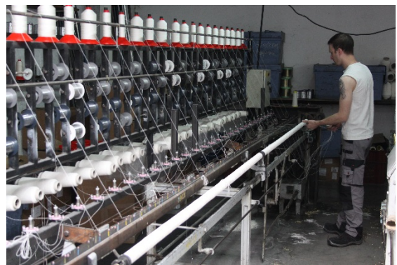
Remplissage des gros rouleaux de chaîne ou ensouples (à gauche) et remplissage des petits rouleaux (à droite) –
