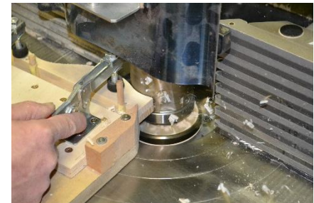
Figure 28b : Opérations d'usinage à l'aide de gabarits sur défonceuse(haut) et toupie (bas), © Sauge Artisan du Bois
