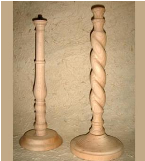
Figure 15 : Exemple d'objet tourné : Pieds cannelés torsadés, tournerie sur bois Froissard Quarroz
