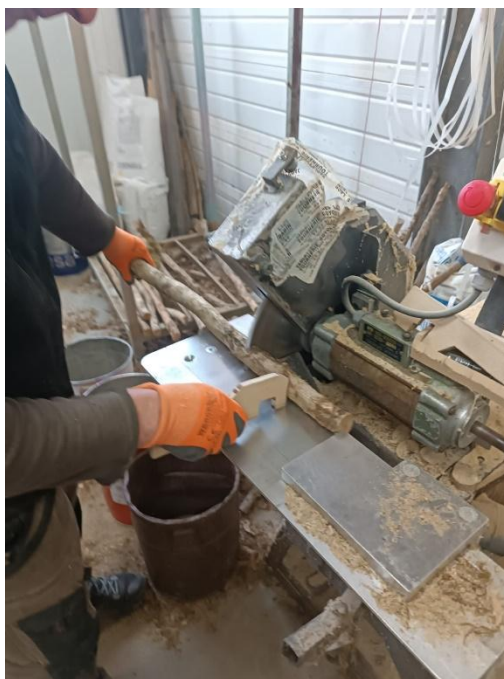
Figure 17 : sciage du buis, Tableterie des lacs
