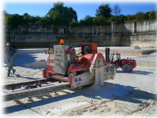
Exemples d'engins et outils modernes à la carrière Constant : au premier plan une haveuse, un élévateur au second plan.
