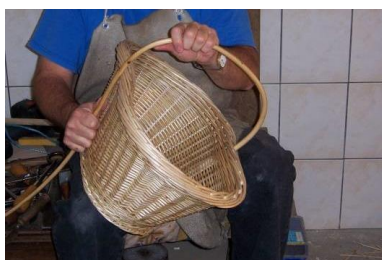
Figure 130 - Pose de la sous-anse
