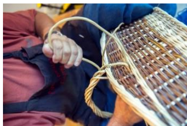
Figure 133 - Attache de l'anse au panier
