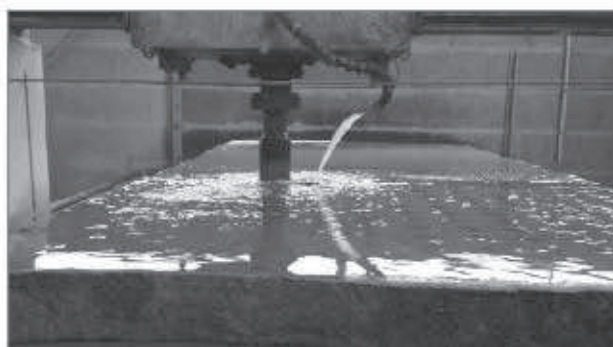
Machine à fabriquer des dalles podotactiles 10 (Source : C. Corlay)
