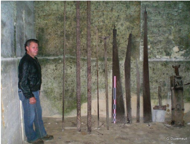
Outils des carrières au XIXe – début XXe siècle en Périgord, présentés par Jean-Noël Boucau. On reconnaît de gauche à droite : une aiguille, deux pincés à talon, une aiguille, une piche, quatre scies crocodile, un marteau taillant et un cric..... (Source : G Duverneuil)
