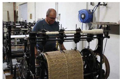
Perçage automatique (à gauche) , laçage des cartons (à droite) - Source : FFBD/Solstiss
