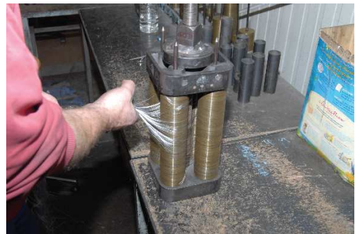
Remplissage des bobines de fil (à gauche) et préparation du pressage à chaud des bobines (à droite) - Source : FFDB
