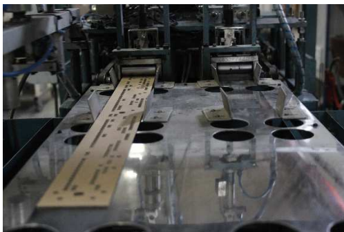
Perçage automatique (à gauche) , laçage des cartons (à droite) - Source : FFBD/Solstiss
